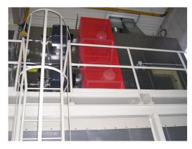
воздуха на выходе приблизительно на 50°C больше чем температура воздуха на входе. Установка часто интегрирует прямо в собственную сушильную камеру.
